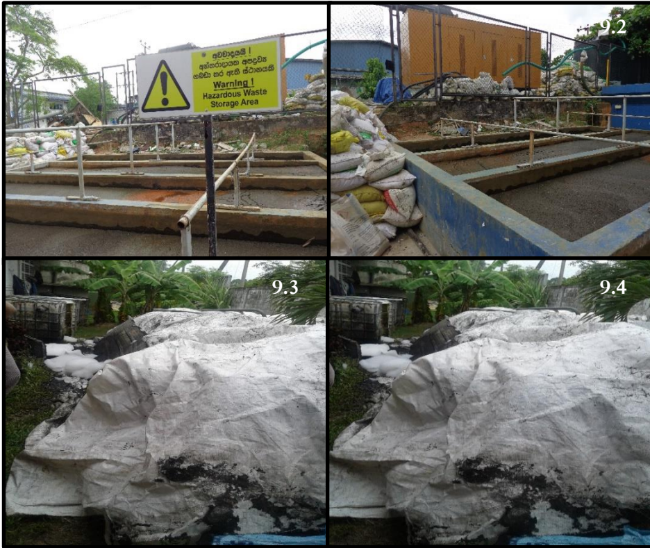
බියගම අපනයන සැකසුම් කලාපයේ කර්මාන්තශාලාවක ජනනය වූ මඩිති විවෘත භූමියක තැන්පත් කර ඇති ආකාරය
